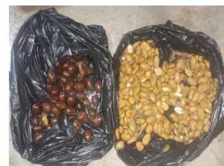
Gambar 8. Hasil pengujian dengan 420 rpm dan jarak celah 2mm
