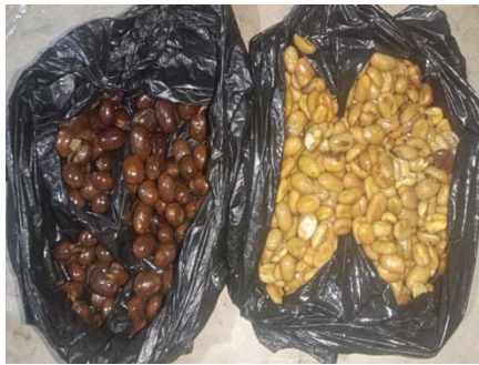
Gambar 6. Hasil pengujian dengan 350 rpm dan jarak celah 2mm
