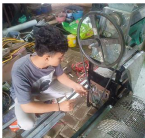
Gambar 11. Mengatur kecepatan motor dengan pulley
