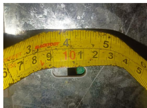
Gambar 14. Pengaturan jarak celah 4mm
