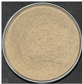
Gambar 4. 3 Hasil Giling Kecepatan Putar Mesin 2600 RPM
