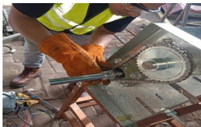
Gambar 20. Pemasangan Pillow Block Ke Poros
