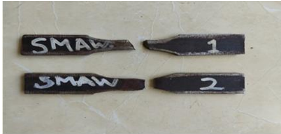
Gambar 1. Spesimen Pengelasan SMAW Setelah Uji Tarik
