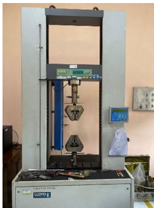
Gambar 3. Mesin Uji Tarik LLOYD LR150K yang terhubung dengan Komputer
