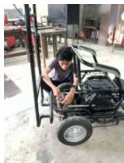
Gambar 6. Pemasangan Motor BLDC Sumber: (Dokumentasi pribadi)
