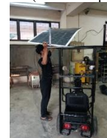
Gambar 9. Pemasangan Panel Surya Sumber: (Dokumentasi pribadi)
