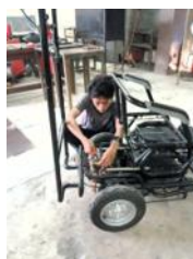
Gambar 6. Pemasangan Motor BLDC Sumber: (Dokumentasi pribadi)
