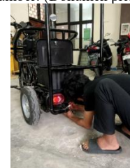
Gambar 12. Pemasangan Baterai SLA Sumber: (Dokumen pribadi)
