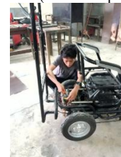
Gambar 10. Pemasangan Rangka Panel Surya Sumber: (Dokumen pribadi)
