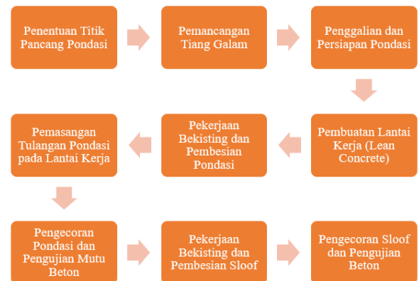
Gambar 3. Langkah-Langkah Pekerjaan Struktur Pondasi
