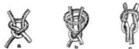
Gambar 4. Ilustrasi simpul yang digunakan : (a) Simpul bendera (English knot); (b) simpul bendera ganda (double English knot); dan (c) simpul mati. (Partosiwiryono, 2016 : 69)
