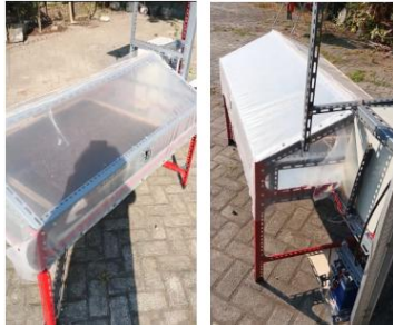
Gambar 4. Implementasi Alat Pengereng Cengkeh Greenhouse
