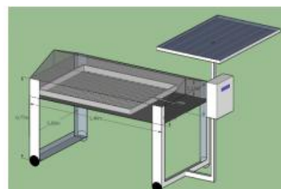
Gambar 2. Rancangan Desain Alat Pengering Cengkeh Greenhouse Berbasis PLTS dengan Pengendalian Suhu dan Monitoring IoT
